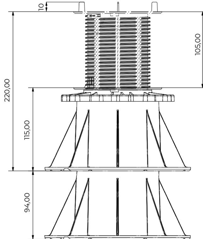
Jede Basis hat eine spezielle Unterform, die es ermöglicht, auf einer anderen Basis stapel zu sein.
