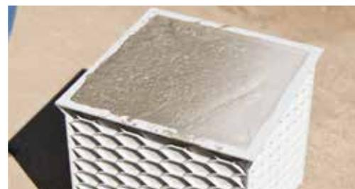
Attendere la completa maturazione del provino per la realizzazione dei test (28 gg).
