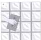
8. Stendere la finitura riempiendo bene le fughe con **spatole e frattazzi** morbidi. Eseguire un cordone perimetrale, oppure parte della fuga esterna, con un **sigillante elastico** per evitare eventuali fessurazioni lungo i giunti di dilatazione/assestamento. In caso di pareti **fortemente esposte all'acqua**, verniciare con **prodotti protettivi trasparenti** le fughe, allo scopo di aumentare l'impermeabilità.
