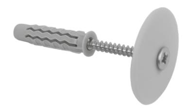
Il KIT ANTISFONDELLAMENTO BASSO SPESSORE è un sistema di fissaggio utilizzato nei sistemi per la messa in sicurezza dei solai in latero cemento. La geometria ribassata della rondella (5 mm) ne permette l'applicazione anche quando sono previsti strati di finitura in basso spessore.
