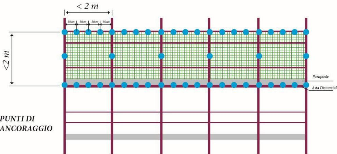
Nel montaggio della rete con l'impiego delle fascette si consiglia di posizionare la fibbia della fascetta, durante l'operazione di serraggio, in qualsiasi posizione evitando quella prospiciente la direzione di camminamento. Tale semplice accorgimento consentirebbe di evitare impigliamenti al personale in transito e l'eventualità di azionare in modo accidentale la linguetta della fibbia allentando di conseguenza la fascetta.
