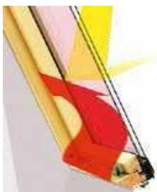
La fenêtre présente une grande surface vitrée, ce qui permet de faire entrer davantage de rayonnement dans la pièce. Toutes les fenêtres sont équipées d'un double vitrage avec une cavité remplie de gaz inerte, qui assure une excellente isolation thermique et acoustique.
