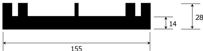
Pour soulever les sols en grès et les dalles de béton, en facilitant l'écoulement de l'eau et en évitant le contact direct avec toute imperméabilisation.
