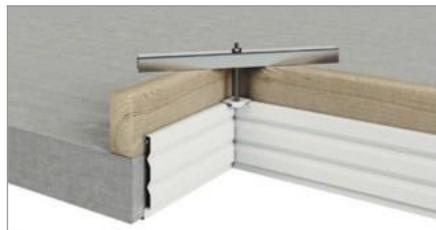
Installation avec une épaisseur de mur supérieure au cadre
